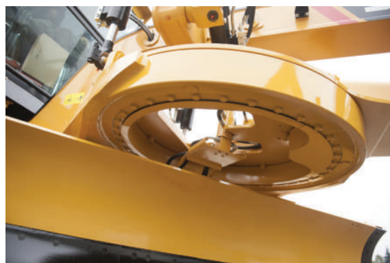
Рабочее устройство опорно-поворотного подшипника
