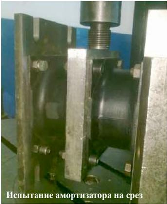
Испытание амортизатора на срез
