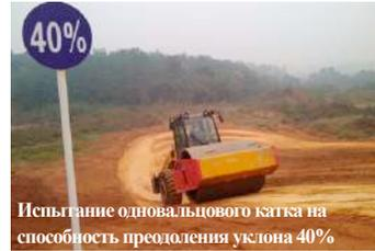
Испытание одновального катка на способность преодоления уклона 40%
