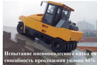
Испытание пневмоколесного катка на способность преодоления уклона 40%
