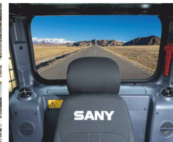
СТЕКЛО ЗАПАСНОГО ВЫХОДА: На случай аварийной ситуации
