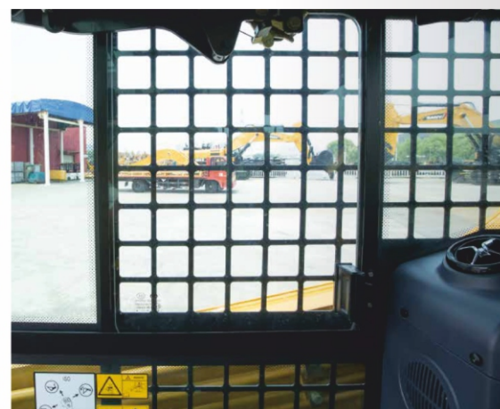
ЗАЩИТНАЯ СЕТКА: Защищает от травм, вызванных падением камней, обломков материала и тд.
