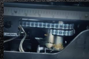
Электромеханизм регулировки разницы в высоте
